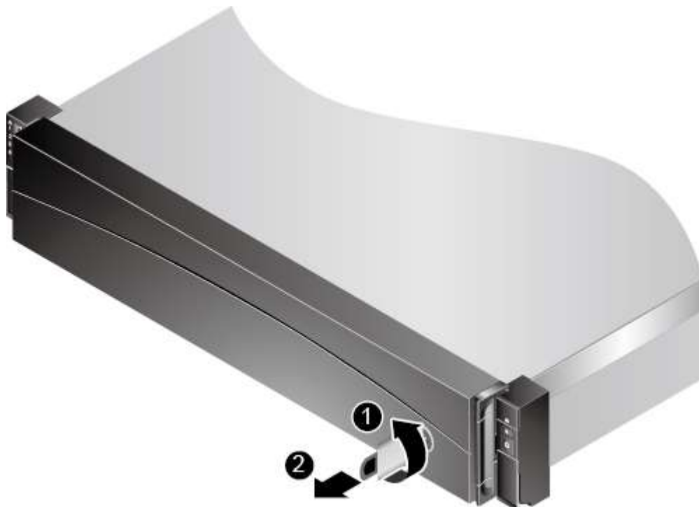
Рис. 5-4 Блокировка передней панели
