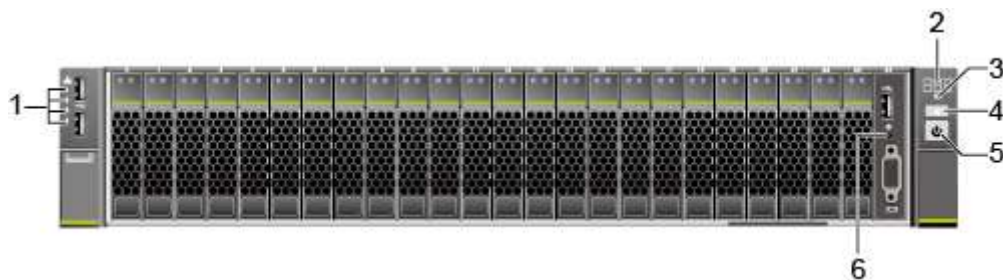
Рис. 2-8 Индикаторы и кнопки на передней панели сервера с двадцатью четырьмя 2,5-дюймовыми передними жесткими дисками
