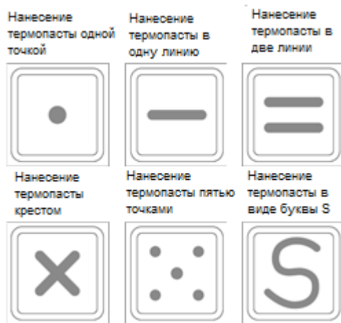
Рис. 5-41 Способы нанесения термопасты
