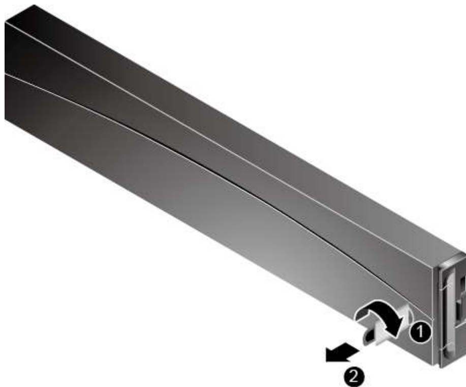
Рис. 5-1 Разблокирование передней панели
