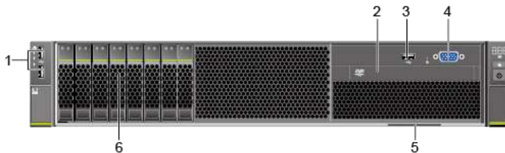
Рис. 2-1 Компоненты на передней панели сервера с восемью 2,5-дюймовыми жесткими дисками
