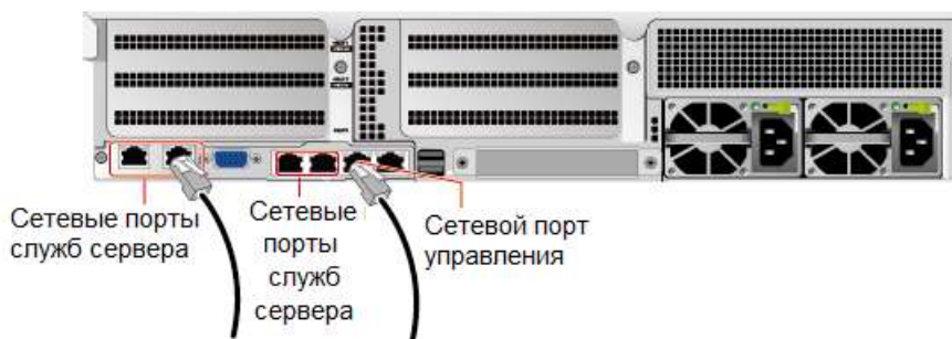
Рис. 4-14 Подключение сетевого кабеля
