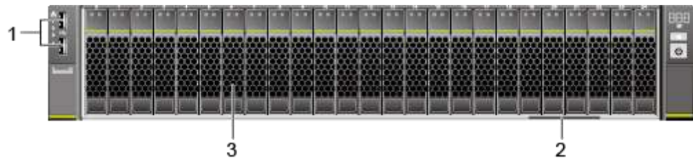
Рис. 2-4 Компоненты на передней панели сервера с двадцатью пятью 2,5-дюймовыми передними жесткими дисками
