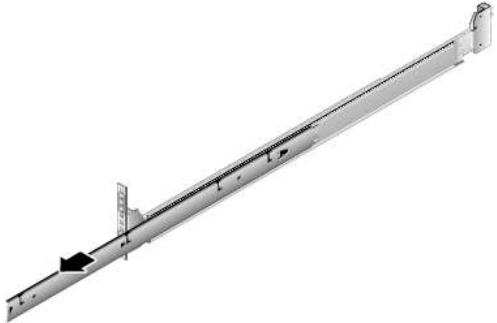
Рис. 4-8 Вытаскивание внутренних рельсов
