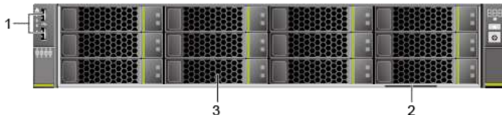
Рис. 2-2 Компоненты на передней панели сервера с двенадцатью 3,5-дюймовыми передними жесткими дисками
