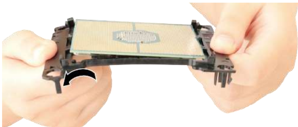
Рис. 5-40 Установка другого края процессора
