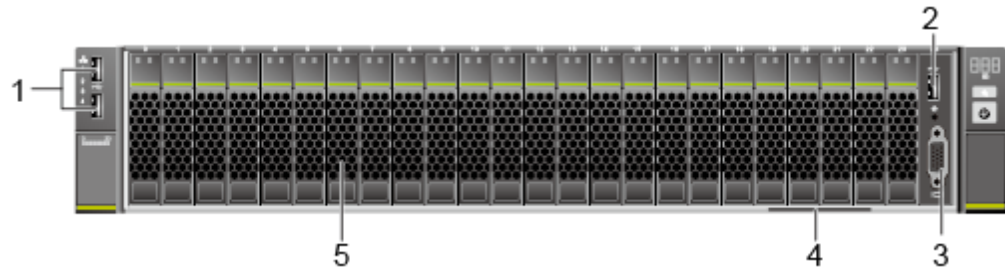
Рис. 2-3 Компоненты на передней панели сервера с двадцатью четырьмя 2,5-дюймовыми передними жесткими дисками
