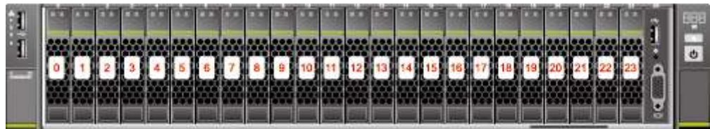
Рис. 2-24 Сервер с двадцатью четырьмя 2,5-дюймовыми передними жесткими дисками (сквозной сервер)
