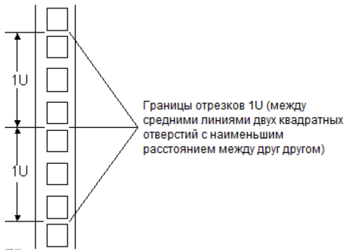
Рис. 4-1 Деление монтажной планки шкафа на отрезки 1U
