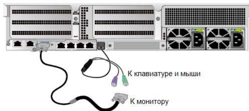
Рис. 4-13 Подключение кабелей PS/2 и VGA
